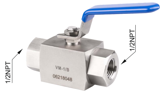
Zawór spustowo-odcinający, kulowy VM-1/B Materiał – stal 316 Temperatura czynnika do 80°C Ciśnienie maksymalne 10 MPa
